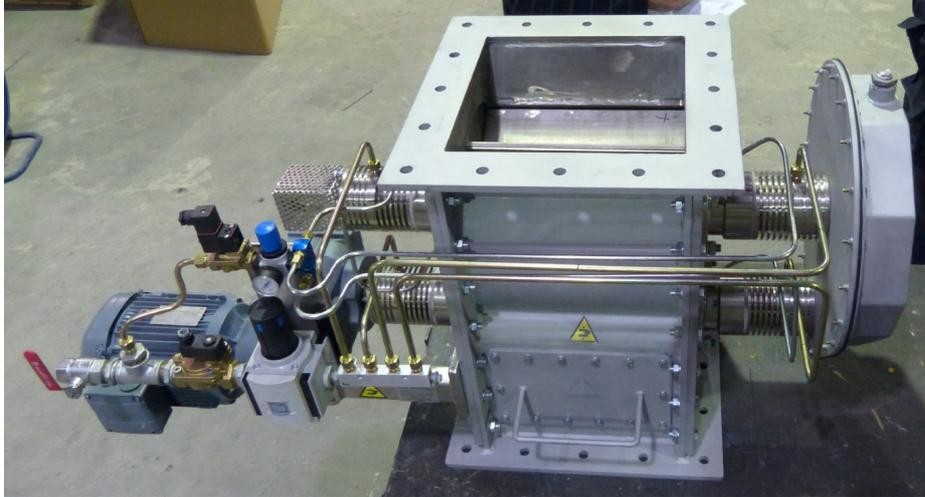
Die Räumradschleuse Typ RRS-Heavy-HT besitzt eine außenliegende, weit abgesetzte Hochtemperatur-Lagerung inkl. Kühlluft-Versorgung mit Magnetventil, Druckregler und Festverrohrung. Die Wellenabdichtung hat Stopfbuchspackungen mit Spülluft-Versorgung inkl. Magnetventil, Druckregler und Festverrohrung.
