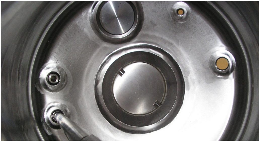
Innenansicht: Scheibenventil und Armaturen-Anschlüsse
